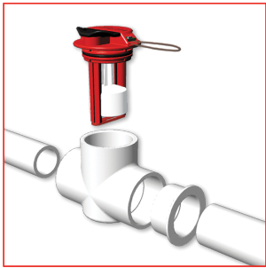
FIG. A: PIPE INLINE
